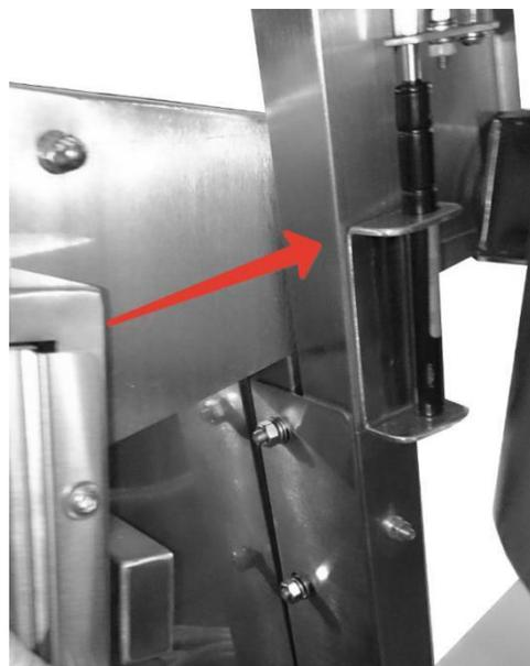
Conecte el imán eléctrico. Aísle las juntas si es necesario.
